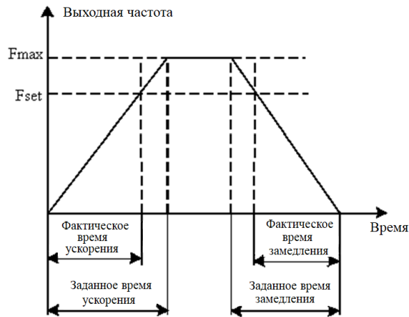
Рис. 6-2 Схема времени ускорения/замедления
