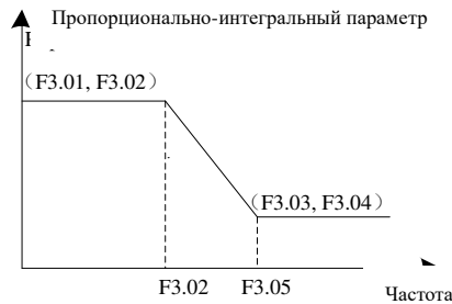
Рис. 6-7 Схема пропорционально-интегральных параметров контура скорости
